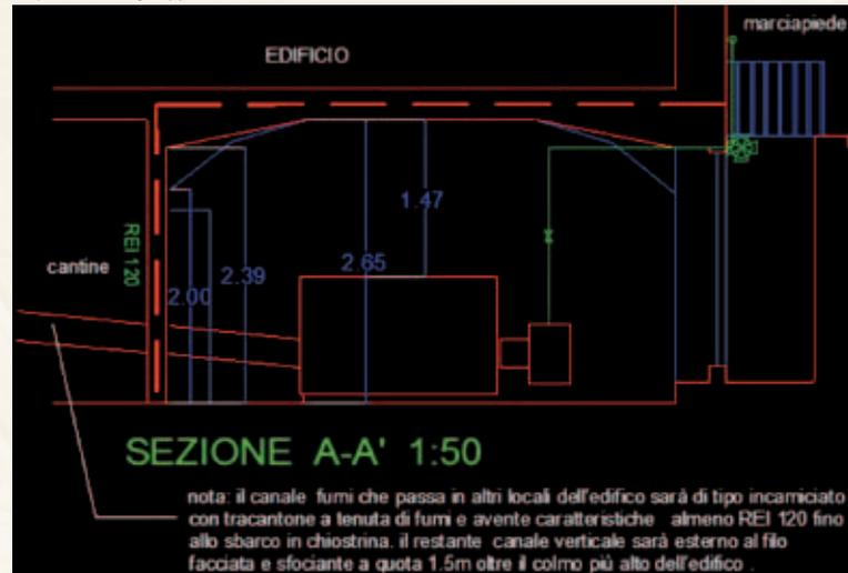
cessibilità agli organi di regolazione, di sicurezza e di controllo anche per la necessaria manutenzione degli stessi. Tra la caldaia e le pareti sarà lasciato uno spazio libero non inferiore a 64 cm. Tra la faccia esterna della caldaia in corrispondenza del bruciatore e la parete prospiciente intercorrerà una distanza di 1,60 m e tra la parete superiore della caldaia e il soffitto si avrà una distanza di 1,47 m.
